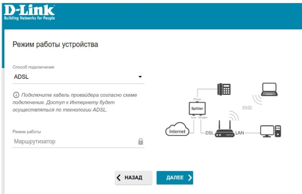
Рисунок 23. Выбор режима работы устройства. Режим ADSL.
