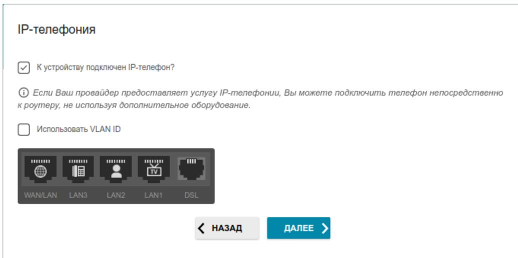
Рисунок 32. Страница выбора LAN-порта для подключения VoIP-телефона.
